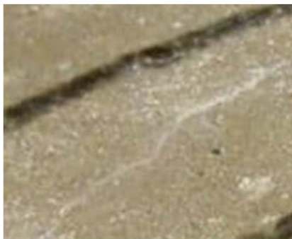
خودترمیمی در نمونه حاوی نانوسیلیکا و باکتری پس از گذشت ۲۰ روز
